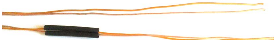
Рис. 3 . Термоусаживаемые гильзы надеты на жилы одной пары.
